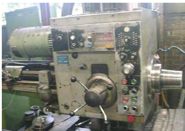
Obr. 23 Ovládací panel vodorovné vyvrtávačky WHN 10B, 1985 [71]
