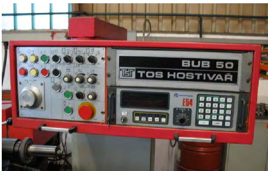
Obr. 35 Ovládací panel hrotové brusky BUB 50, 1990 [81]
