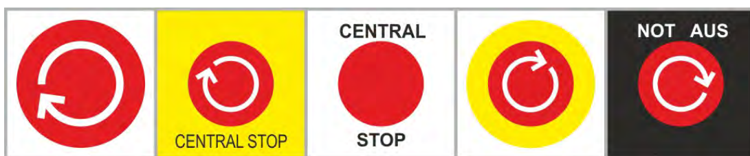
Obr. 6.13 CENTRAL STOP – varianty, objevující se na panelech
