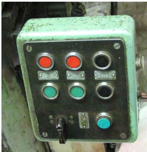
Obr. 8 Ovládací panel rovinné brusky TOS BPH 20, 1965 [63]
