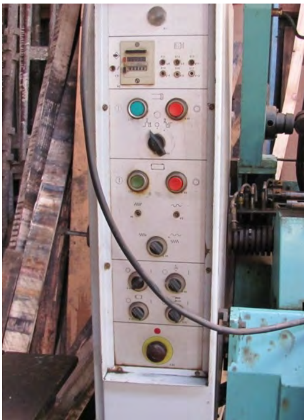
Obr. 29 Ovládací panel soustruhu TOS AWA 16, 1987[76]
