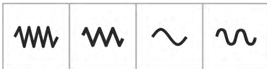
Obr. 6.16 Symboly pro posuv – varianty pro posuv a rychloposuv
