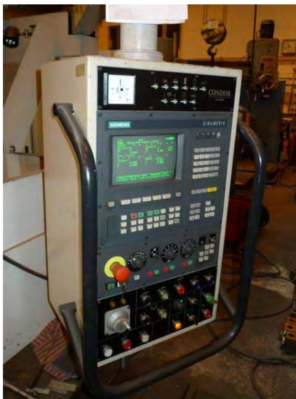
Obr. 28 Ovládací panel karuselu TOS SKI 8, 1987 [75]
