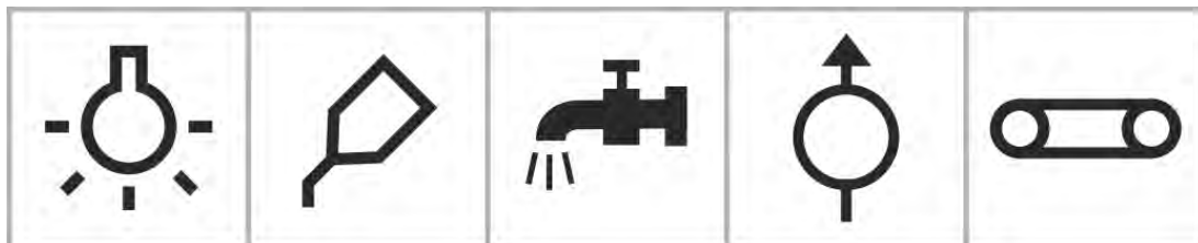
Obr. 6.15 Symboly pro osvětlení, mazání, chlazení, čerpadlo a dopravník
