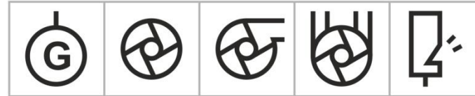
generátor rotační kompresor ventilátor vývěra píšťala
