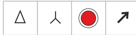
přepínač pro zapojení hlavního motoru přepínač pro zapojení hlavního motoru tlačítko stop posuvů nastavení směru šikmého frézování
