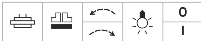
náhon rotačních nástrojů pootáčení/upínání upínací desky vlevo/vpravo přepínač osvětlení stroje vypnuto/zapnuto
