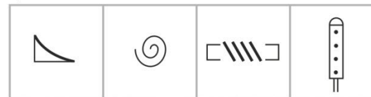
signálka kopírování suportu předvolba řezání čelních spirálových drážek předvolba řezání závitů uzamykací spínač volby panelu
