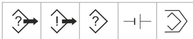
přeplněná paměť varování před přeplněním paměti chyba paměti baterie paměť programu
