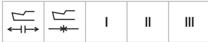
ruční povolení držáku zpevněná revolverová hlava převodový stupeň otáček převodový stupeň otáček převodový stupeň otáček
