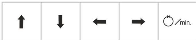
přímočarý pohyb směr nahoru přímočarý pohyb směr dolů přímočarý pohyb směr doleva přímočarý pohyb směr doprava otáčky vřetena
