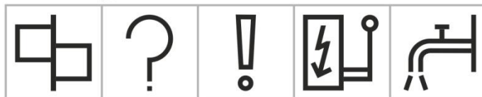
zajištění střížným kolíkem chyba pozor hlavní vypínač chladičí kapalina
