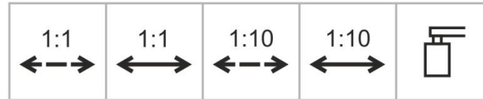
přerušovaný posuv trvalý posuv přerušovaný posuv s předlohou trvalý posuv s předlohou panel
