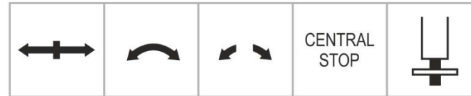
pohyb vpravo/vlevo spuštění otáček vřetena otáčivý pohyb doprava/doleva centrální zastavení stroje přidavné brousící zařízení
