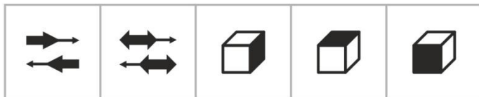
zapnutí rychloposuvu (stejný jako předchozí) zapnutí rychloposuvu (opačný jako předchozí) volba roviny šikmého frézování volba roviny šikmého frézování volba roviny šikmého frézování
