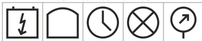
baterie kabina uzavřena hodiny signálka kontrolní světlo měřicí přístroj indikační
