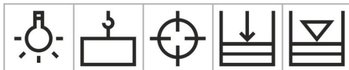
osvětlení stroje hmotnost (číselná hodnota v symbolu) těžiště plnění nádržky kapalinou hladina
