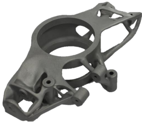
Topologicky optimalizovaná těhlice
