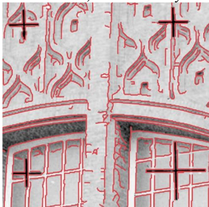
Obr. 3 Výsledek úpravy obrazu Cannyho operátorem – červenou barvou jsou zvýrazněny nalezené hrany [7]
