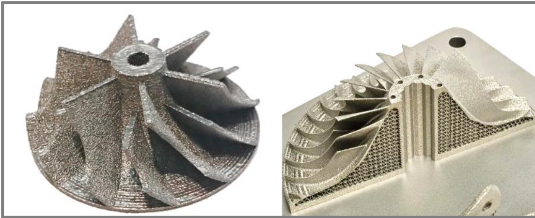
Obr. 2 Porovnání technologií EBM a SLM vlevo díl vytvořený technologií EBM vpravo technologií SLM [3]
