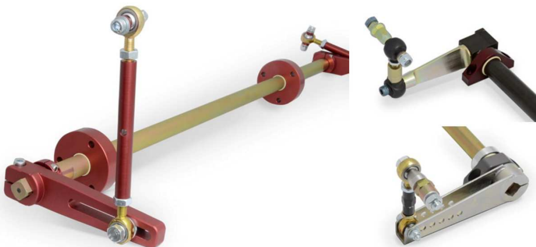
Obr. 18 Stabilizátory s nastavitelnou tuhostí od společnosti Elephant racing [29]
