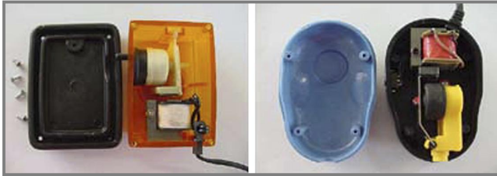
Obr. 3-10 Vnitřní řešení kompresorů pro akvária [9]
