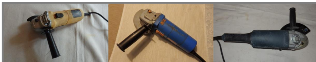
Obr. 6-1 Analyzované úhlové brusky o velikosti kotouče 115/125/230 mm
