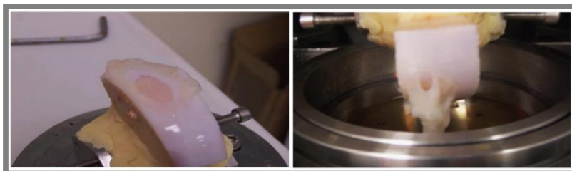
Obr. 3-23 Opotřebená chrupavka z konfigurace AC - SS. [14]
