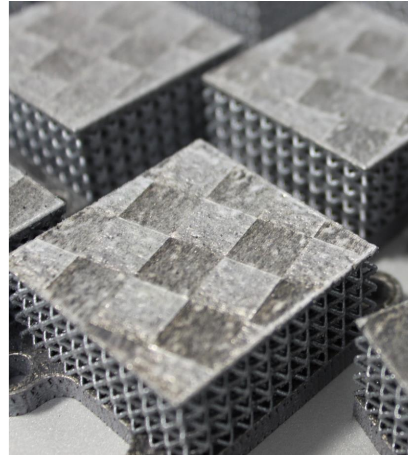
Vzorky pro pádový test po výrobě SLM (NETME Centre)
