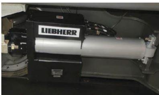
Obr. 2.40 EHA aktuátor pro řízení podvozku vlaku [35]
