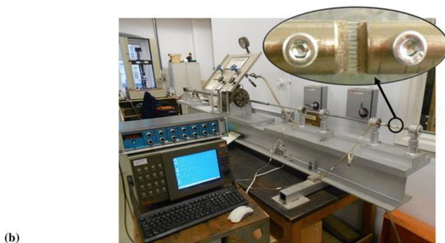
Obr. 3-25 a) Schéma Hopkinsonova zařízení upraveného pro vysokorychlostní tahové zkoušky, b) uchycení vzorku navrženého pro tento typ zkoušky [21]
