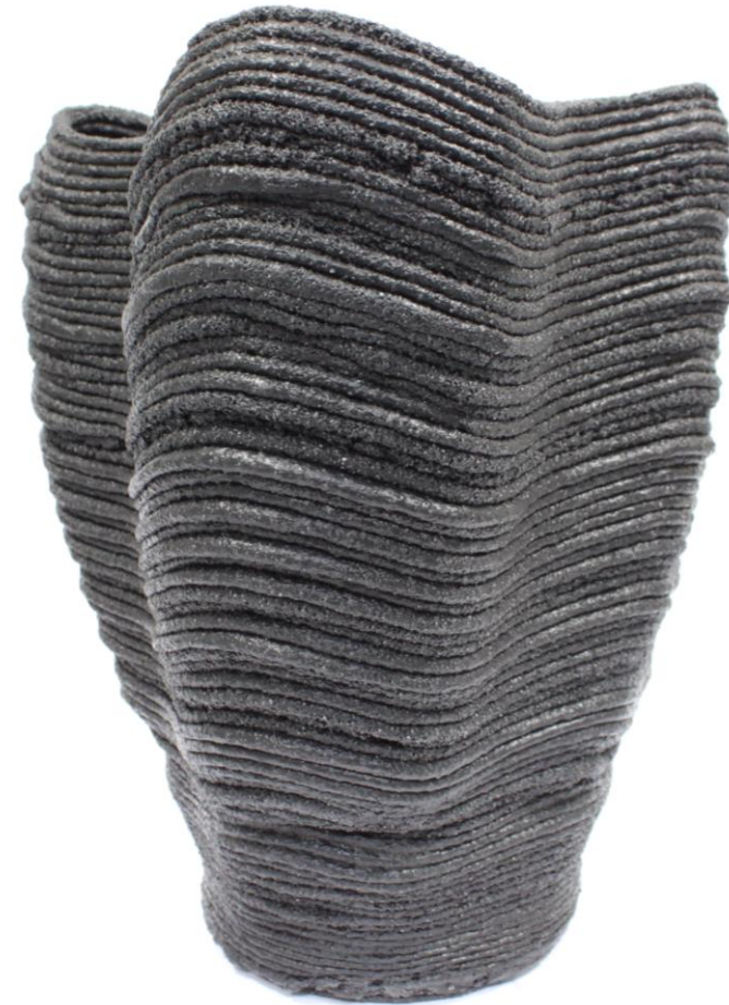
Realizovaný neplanární tisk z polymerního betonu
