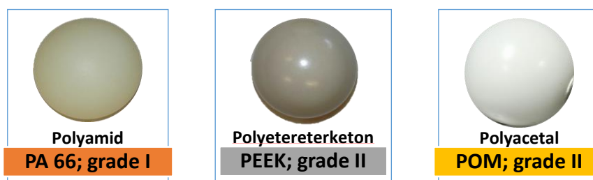
Obr. 61 Polymerní kuličky určené pro experimenty zaměřené na tření v soft EHL kontaktu
