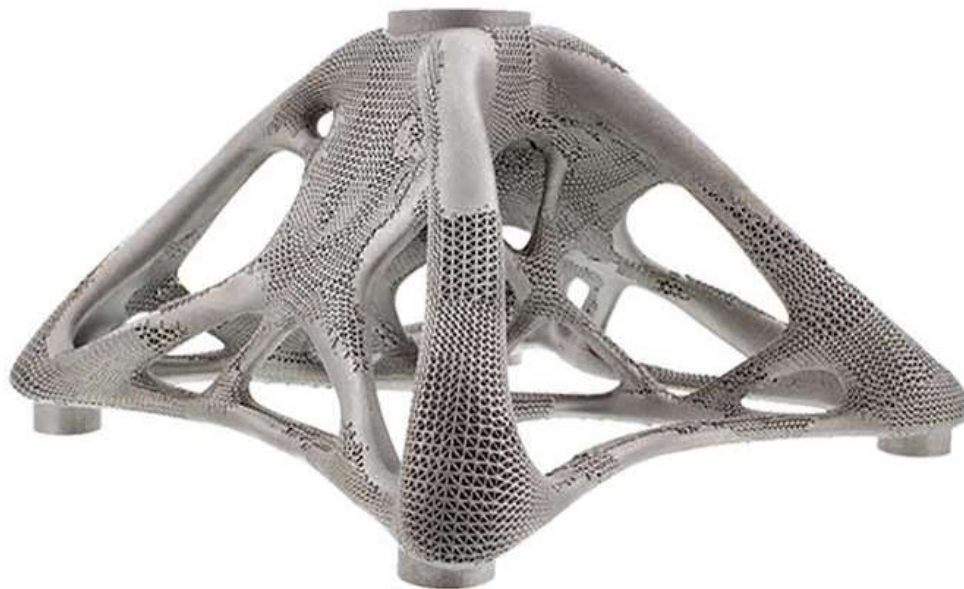
Obr. 3.11: Držák na skleněné desce optimalizovaný společností Altair [25].
