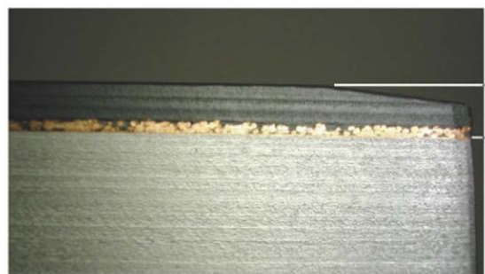
Polymérne kompozitné vrstvy so základom PEEK PAJACZKOWSKI et al. (2010)
