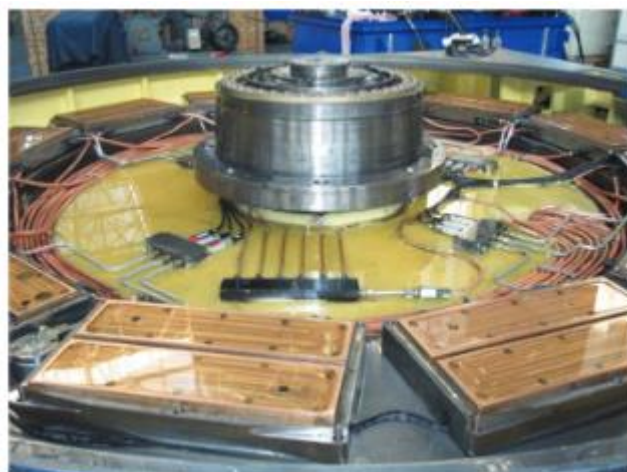
Obr. 3-27 HS ložisko využívané pre experimentálne overenie výsledkov numerických simulácií [54].
