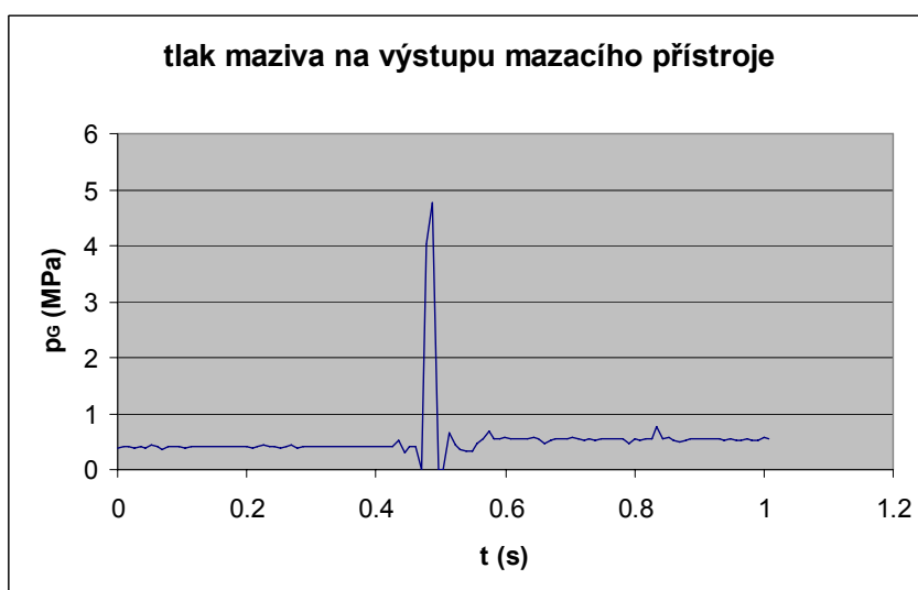
Obr. 22 Grafické výsledky měření tlaku maziva p_G za mazacím přístrojem při zátěži m = 4,4 \text{ kg} na měřicím válci
