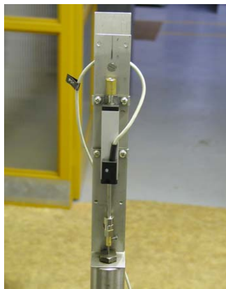
Obr. 8 Zapojení potenciometru na měřicím přípravku
