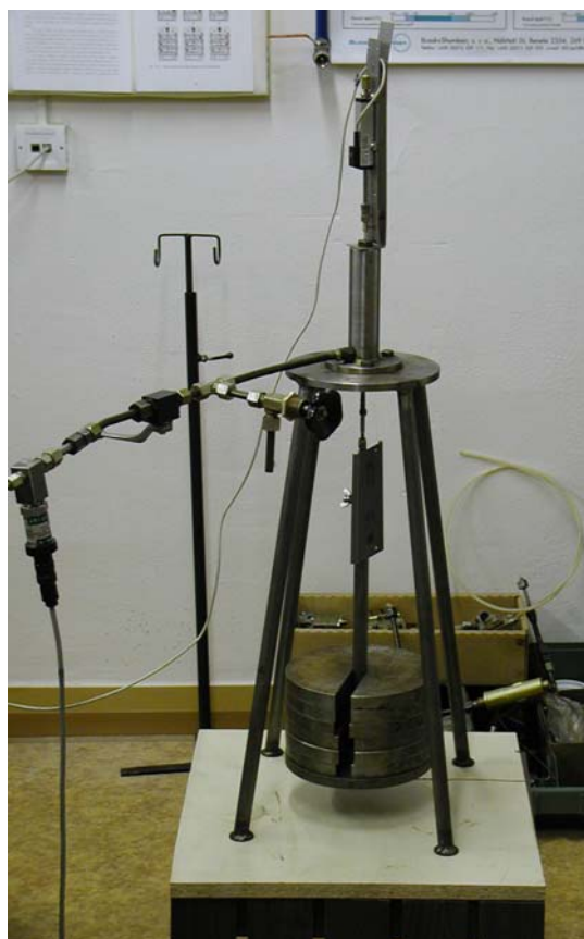
Obr. 6 Měřicí přípravek posuvu a dodaného množství a) standardní zatížení (pro měření na obr. 1) b) velký rozdíl zatížení vývodu (pro měření na obr. 2)
