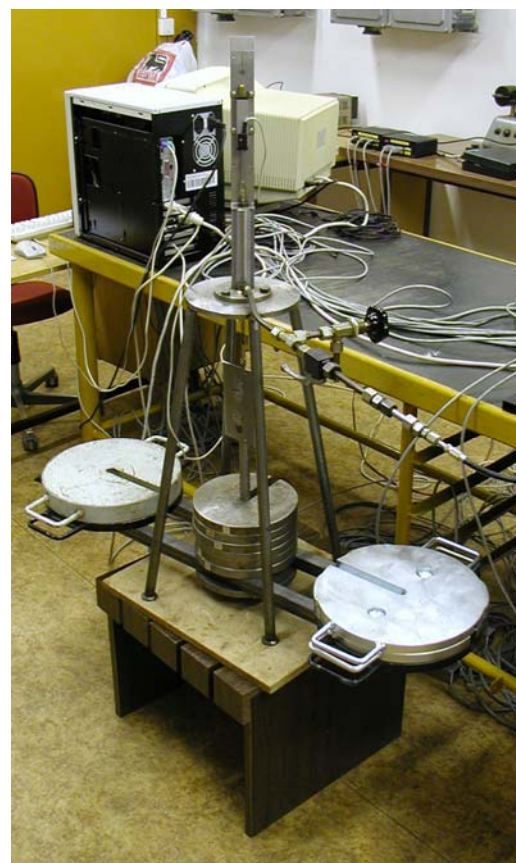
Obr. 6 Měřicí přípravek posuvu a dodaného množství a) standardní zatížení (pro měření na obr. 1) b) velký rozdíl zatížení vývodu (pro měření na obr. 2)
