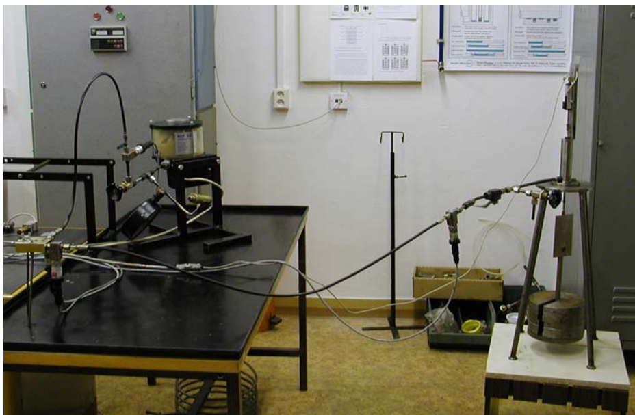
Obr. 13 Měřicí trať pro měření tlakových ztrát na zápichu písku
