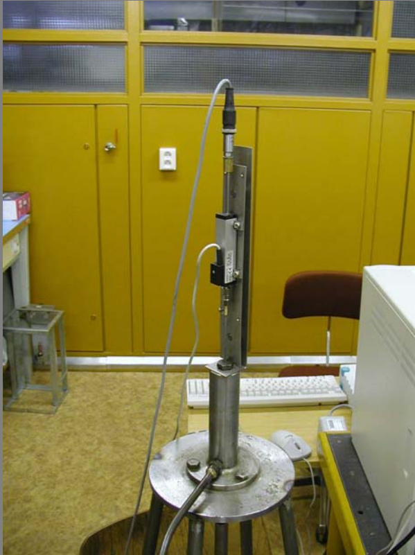
Měřicí přípravek se snímačem pohybu a snímačem zrychlení
