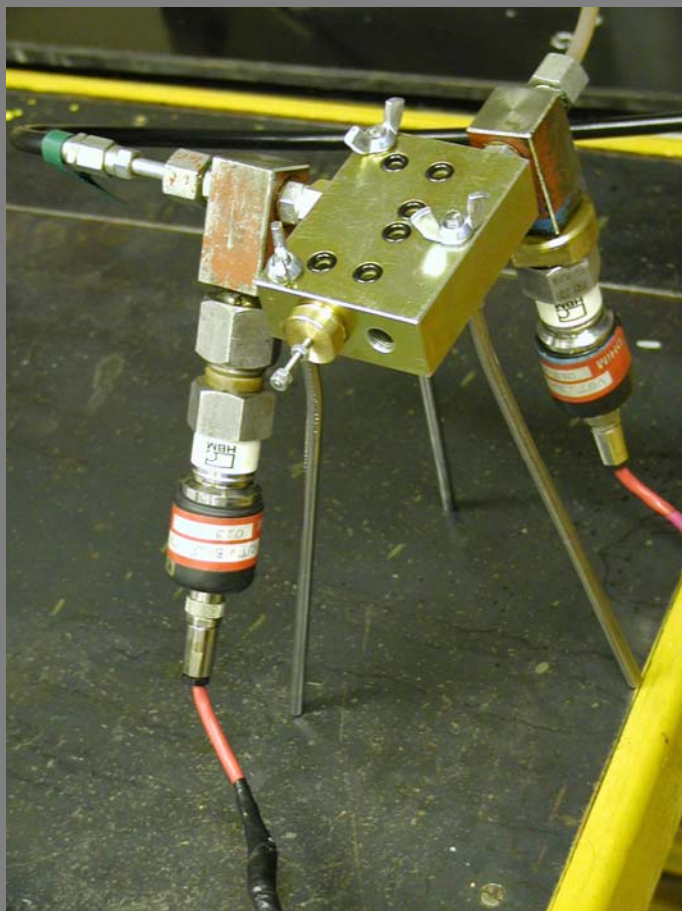
Foto měřicího přípravku pro měření proměnného odporu proti pohybu při toku maziva přes zápich na pístku
