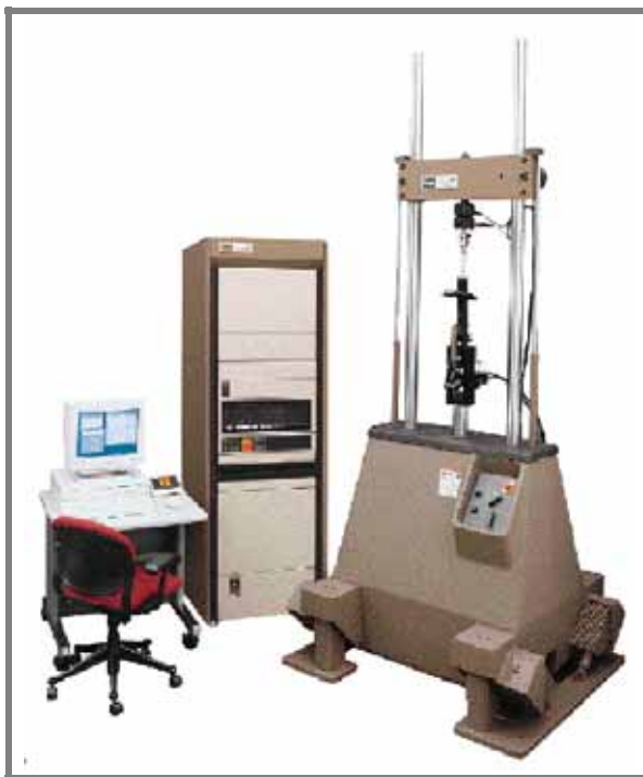
Obr. 4.16 Hydraulická měřicí stolice MTS 850
