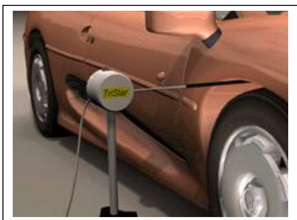
obrázek 13: Impulsní dokmitový test a jeho modelová situace
