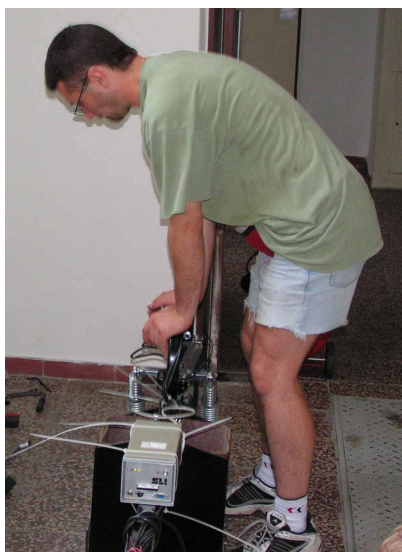
obrázek 50: Test impulsní dokmitový provedený na Experimentálním vozíku
