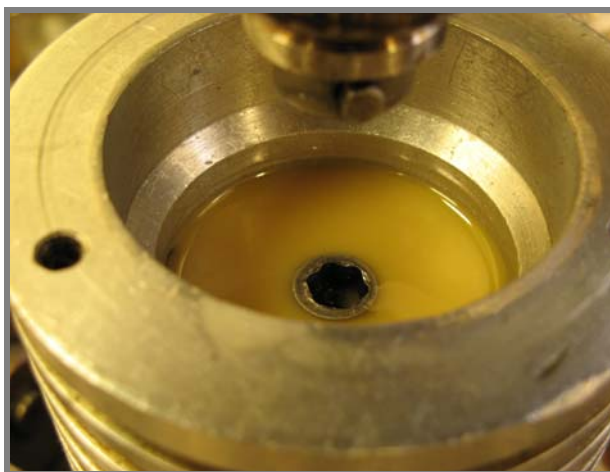
Obr. 25 Příprava emulze mícháním-pohled do olejové vany zařízení
