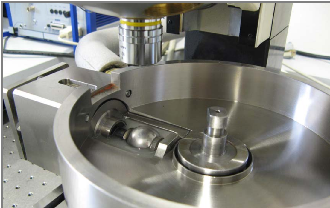
Obr. 49 Optický tribometr před měřením emulze
