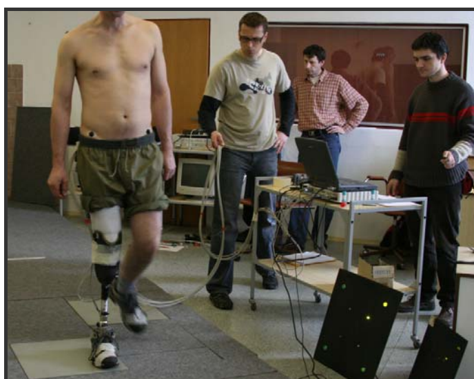
Obr. 8.26: Zatížení tenzometrické desky přes protézu
