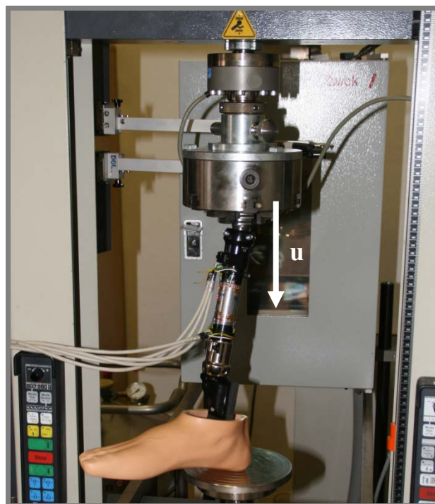
Obr. 8.8: Měření přetvoření na patě chodidla protézy na zařízení ZWICK Z020
