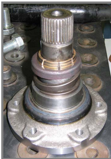
Obr. 7 Sériový unašeč s antiwummern – přitlačná pružina, třecí kroužek
