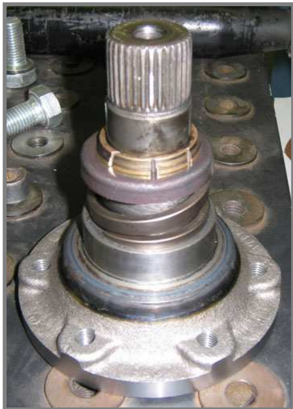
Obr. 6 Sériový unašeč s antiwummern – přítlačná pružina, třecí kroužek
