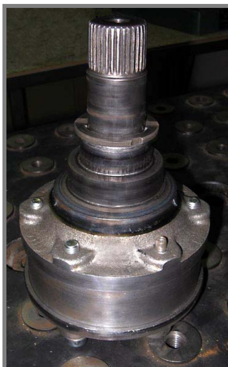
Obr. 34 Sériový unašeč bez pružné vazby (antiwummern)
