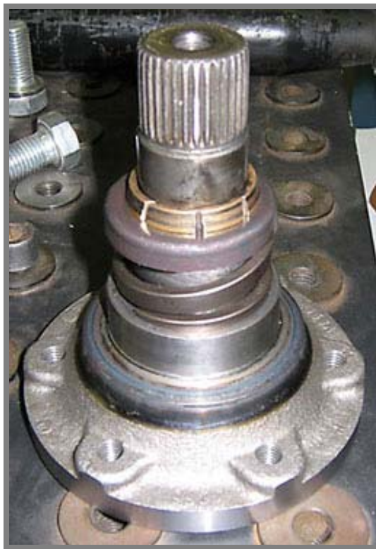
Obr. 32 Sériový unašeč s antiwummern – přitlačná pružina, třecí kroužek
