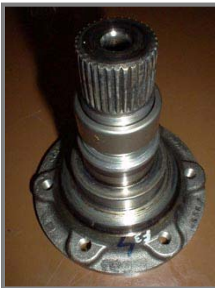
Obr. VIIa Unašeč diferenciálu s nalisovaným polygonálním ložiskem
