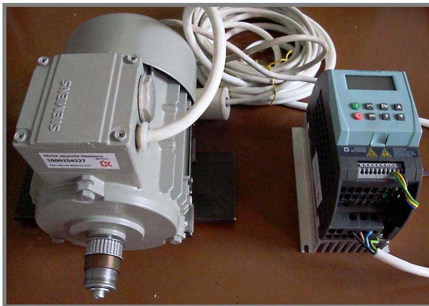
Obr. 24 Pohon stanice – elektromotor s frekvenčním měničem
