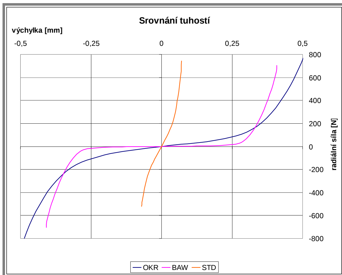
Obr. 49 Srovnání průběhů radiální tuhosti referenčních variant s navrhovanou úpravou uložení (OKR – navržená úprava, BAW – bez antiwummern, STD – varianta s antiwummern)
