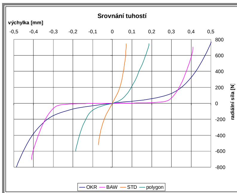
Obr. VIIIb Srovnání průběhů radiální tuhosti pro referenční varianty (BAW, STD), O kroužky (OKR) a uložení s polygonálním ložiskem (polygon)
