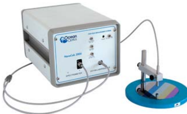
Obr. 3.4 Komerční vláknový reflektometr pro měření odrazivosti firmy OceanOptics [27].
