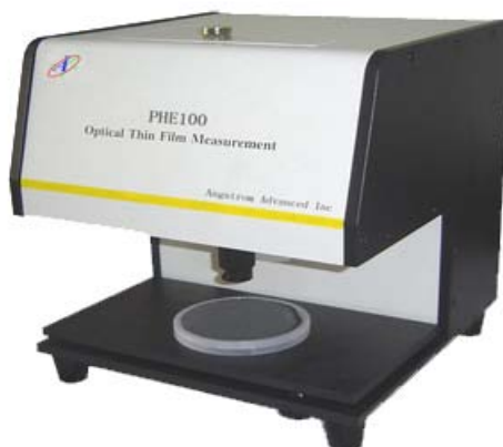
Obr. 3.5 Komerční reflektometr pro měření odrazivosti firmy Angstrom Advanced Inc. [28].
