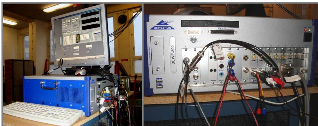
Obr. 5.17 DEWE 800 (a) stanice na měřicím pracovišti; (b) rack se zesilovacími moduly
