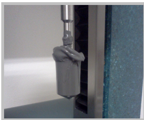
Obr. IV.5 Tepelně degradovaná MR kapalina na senzoru viskozimetru RotoVisco
