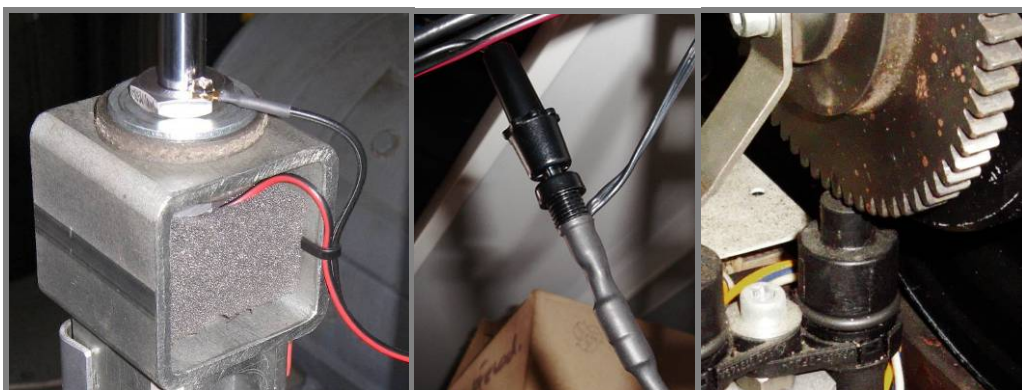
Obr. 5.16 Detail na (a) napájení cívky – měření napětí; (b) bočník; (c) měření otáček pulsátoru
