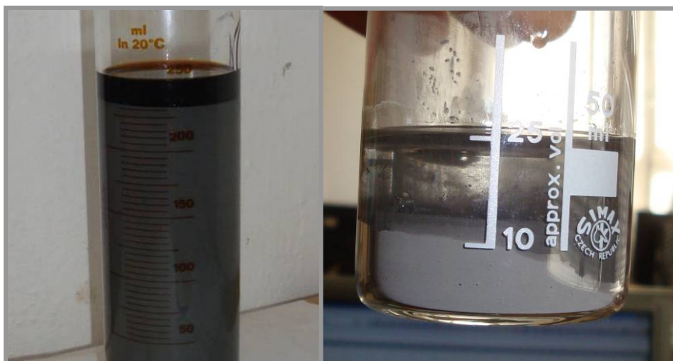
Obr. 6.5 Sediment a separovaná nosná kapalina (a) MRF 140CG; (b) MR kapalina bez aditiv za 2 hod
