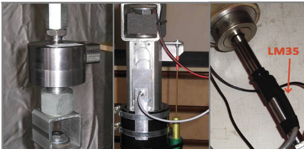
Obr. 5.15 Detail na (a) siloměr HBM U2AD1; (b) indukčností snímač polohy SD2; (c) snímač teploty LM35
