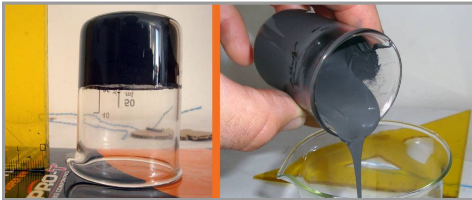
Obr. 6.10 MR kapalina 140CG (a) po temperaci na teplotě 150^{\circ}\text{C} po dobu 2hod; (b) po krátkém rozmíchání
