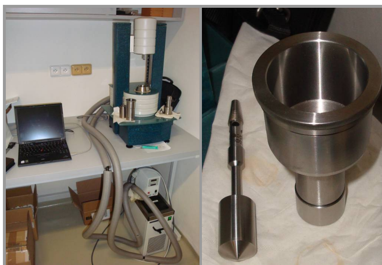
Obr. 5.39 (a) Rotační viskozimetr RotoVisco s chlazením; (b) měřící senzor Z20 DIN Ti s kalíškem
