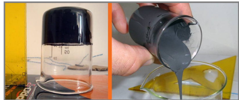
tepelná degradace MR kapaliny
