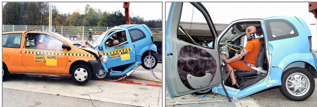
Obr. 2.25 Průběh crashtestu (vlevo) a jeho výsledek [45]
