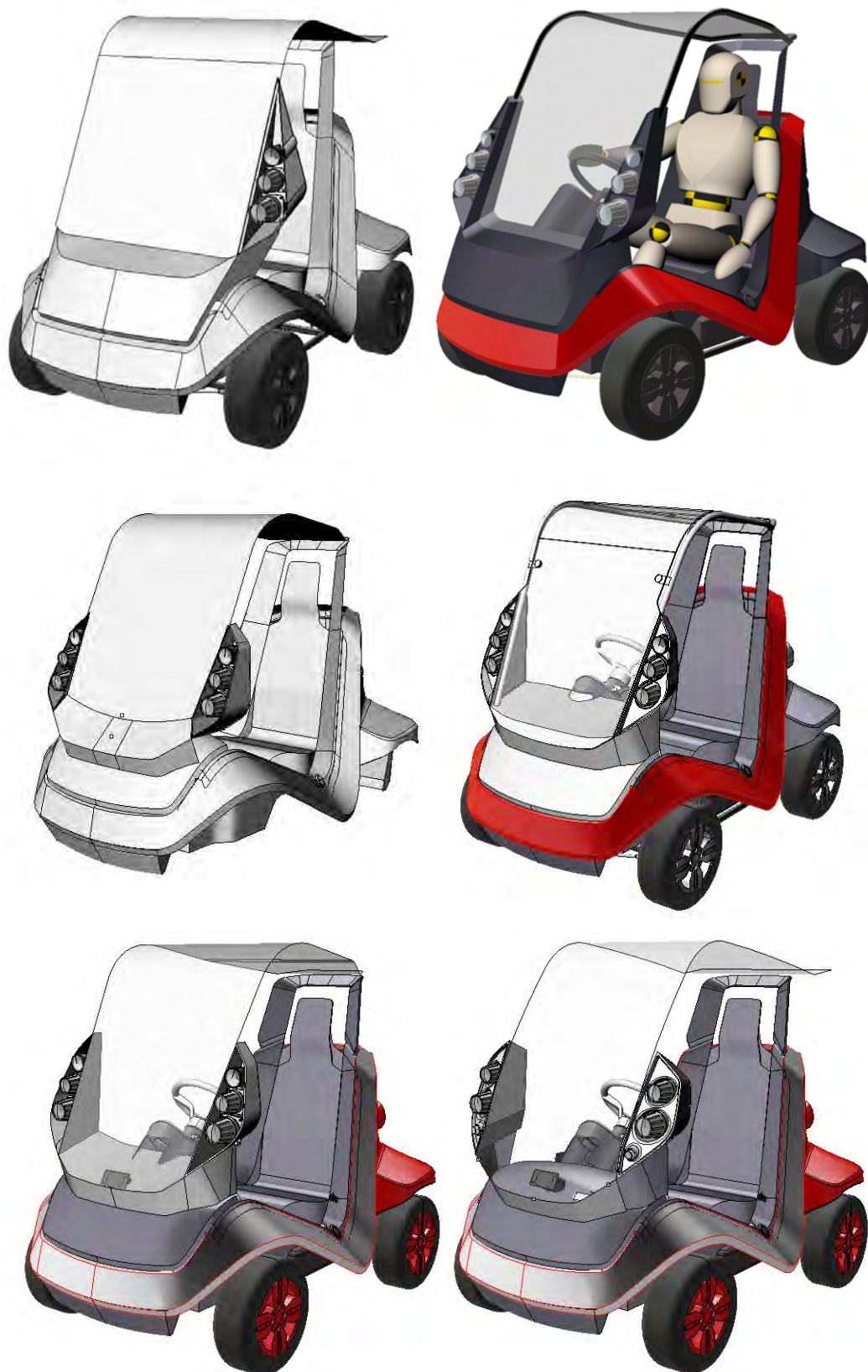
Obr. 6.34 Vývojové etapy proměny přední části. Idea předsazení objemu nad blatníky s následným odsazením ke sklu zcela potlačuje původní myšlenky oddělení dvou objemů i ústřední motiv (nahoře). Návrh uprostřed vlevo pracuje s kontrastním navázáním ploch (konvexní plochy dole a konkávní prolomení sklo-plocha pod prosklením) a tím vytváří nesoulad i snižuje pohledovou tuhost.
