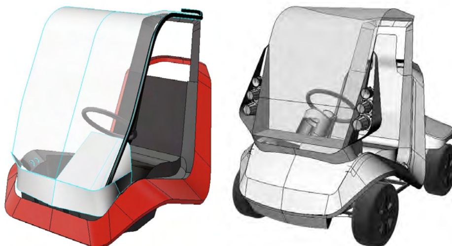
Obr. 6.33 Vývoj návrhu vpředu - odstranění špičky a přechod od lineárního provedení ke konvexnímu pojetí, které zvyšuje optickou tuhost karoserie
