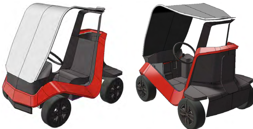
Obr. 6.32 Propojení centrálního motivu v čelní i zadní části a úprava celého prostoru za řidičem
