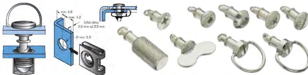
Obr. 6.59 Princip DZUS rychlouzávěrů a jejich typy [63]
