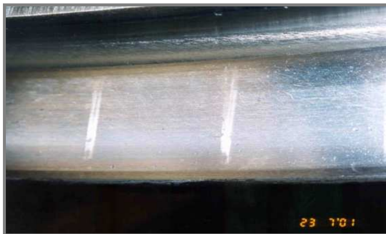
Obr. 29 Ukázka poškození kroužku ložiska (FALSE BRINELLING).
