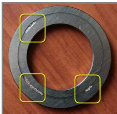
Obr. 34 Výsledné poškození testovaného kroužku.
