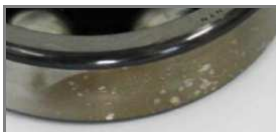
Obr. 10 Koroze na vnějším kroužku ložiska.
