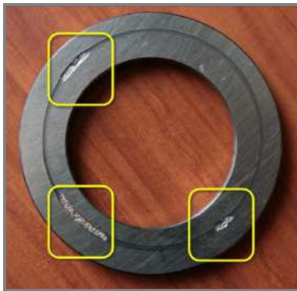
Obr. 2.24 Výsledné poškození testovaného kroužku [31].
