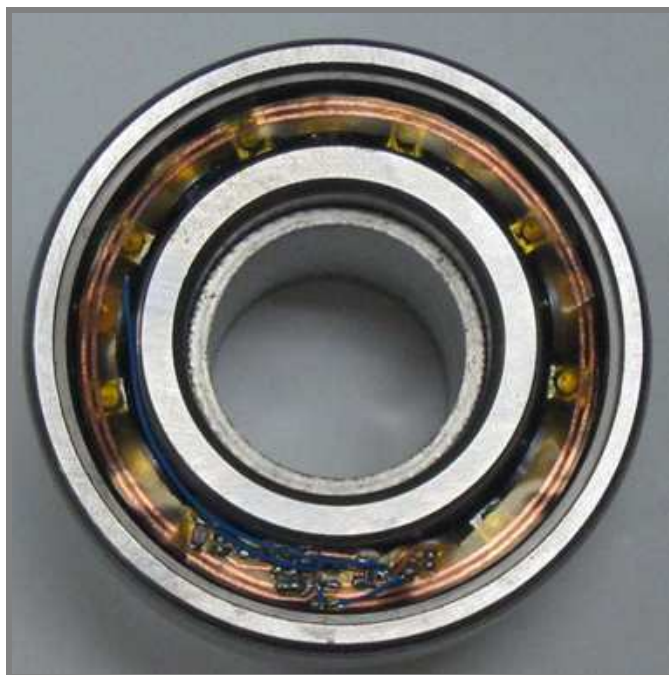
Obr. 2.16 Bezdrátový senzor teploty instalovaný na kuličkovém ložisku [23].
