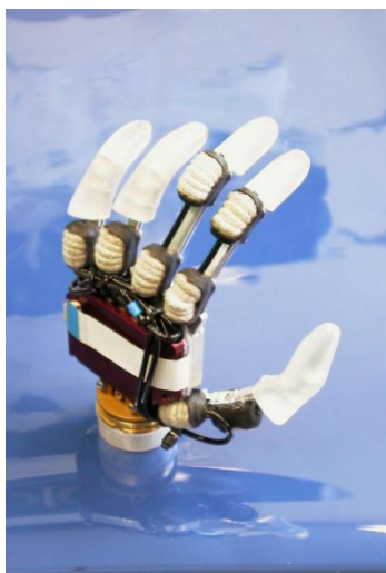
Obr. 39 Hydraulicky poháněný úchop chapadla [49]
