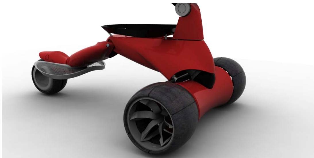
Obr. 6.17 Detail na kyvné upevnění k hnacímu tělesu
