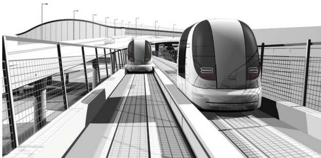
Obr. 6.5 Příklad transmodálního dopravního prostředku [94] PRT na letišti v Heathrow, vize dle ultraprt.com
