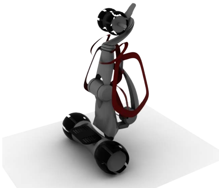
Obr. 6.14 Princip obráceného kyvadla (Segway); obsluha rezidenčních zón
