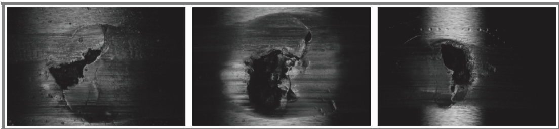
Obr. 34 Příklady poškození se soustavou vtisků v kontaktní stopě
