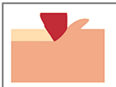
Obr. 83 Mechanismus tvorby textury na povrchu vzorku (Greco a kol.)
