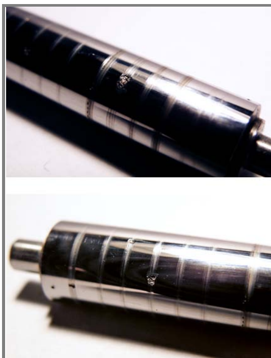
Obr.64 Místo poškození vzorku
