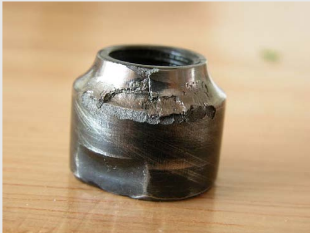
Poškození povrchu pittingem
