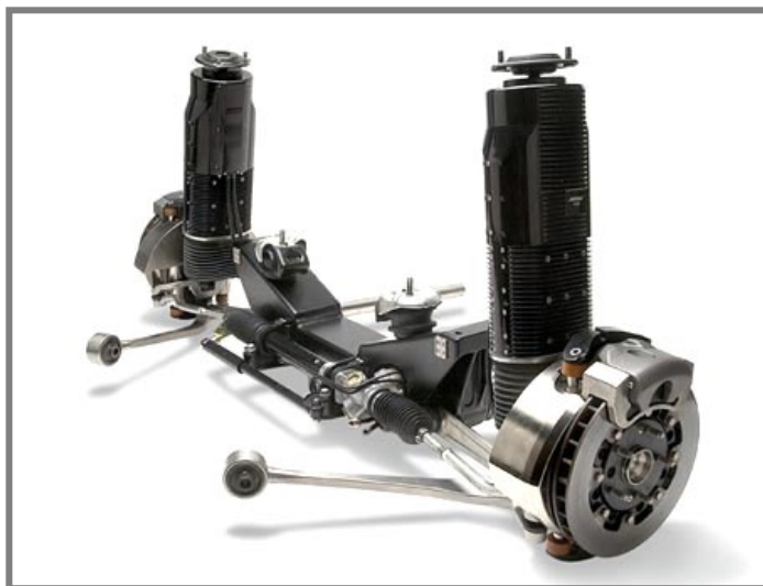
Obr. 2: Závěs BOSE s lineárními elektromotory [3]
