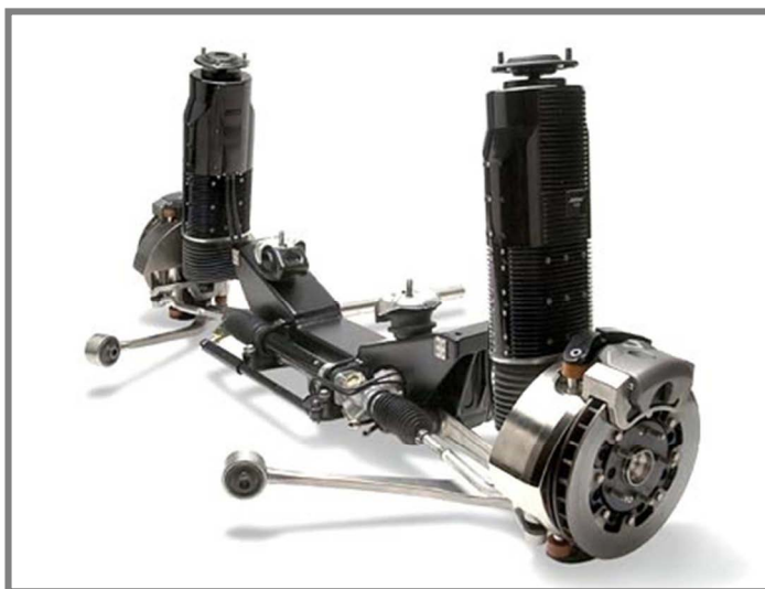
Obr. 1.2: Závěs BOSE s lineárními elektromotory
