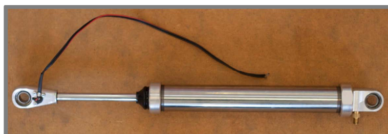
Obr. 5.2: Upravený MR tlumič Delphi
