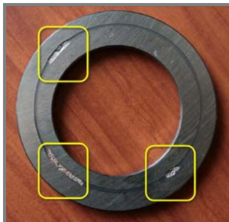
Obr. 20 Výsledné poškození testovaného kroužku [7]
