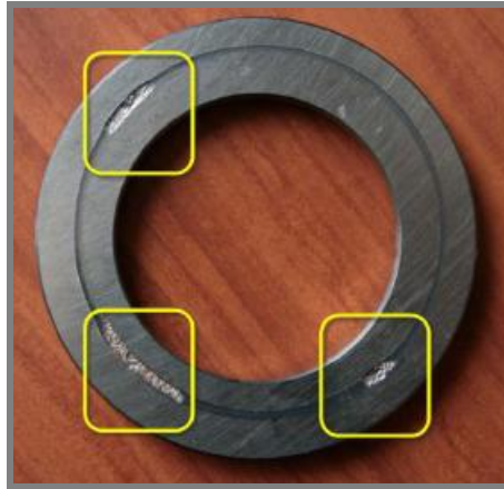
Obr. 16 Výsledné poškození testovaného kroužku [7]
