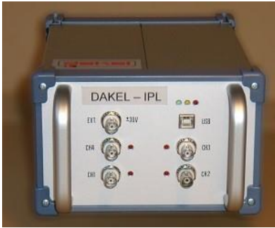
Jednotka DakeI IPL záznam signálu AE progresivní f_{vz}
