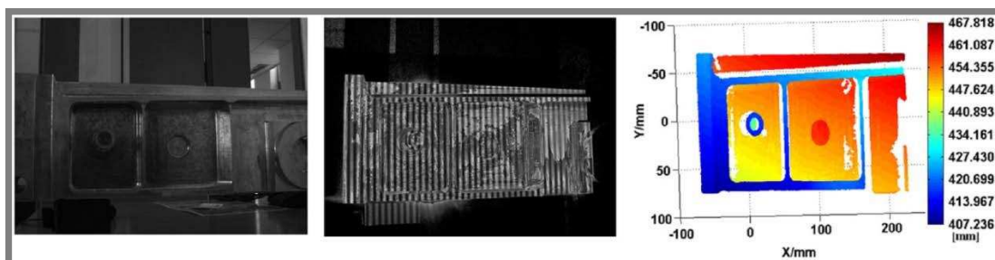
Obr. 17 Měření objektu, snímek s vysokým dynamickým rozsahem a výsledná hloubková mapa [18]
