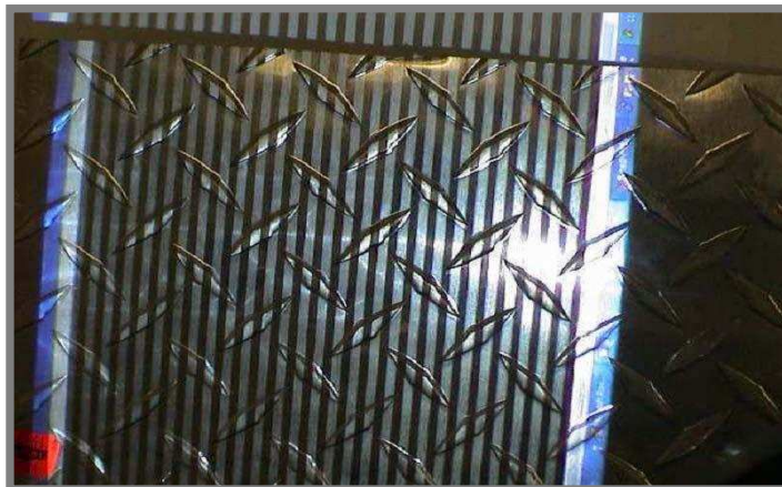
Obr. 11 Ukázka odlesku na měřeném povrchu [14]
